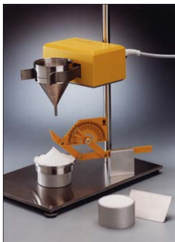
Определение угла откоса с помощью EMS 755
