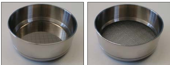
Испытательное сито с гальваническим покрытием (слева) и тканое испытательное сито (справа)
