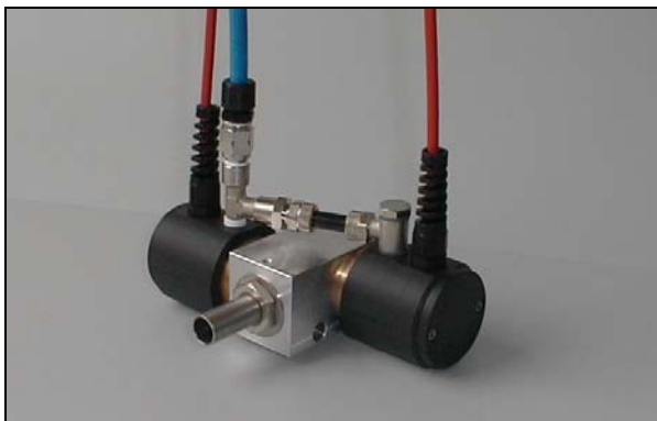
Смесительная камера с ионизационными головками
