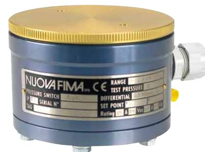
Эти диафрагменные реле давления имеют уровень защиты IP 55 и используются в химической промышленности petrolchiica и обычных электростанций. Чувствительным элементом является металлическая диафрагма, и она воздействует непосредственно на микровыключатель через самоцентрирующийся шарнир. Простота конструкции, без рычагов, кулачков или подобных механизмов обеспечивает для устройства исключительно длительный рабочий ресурс.
