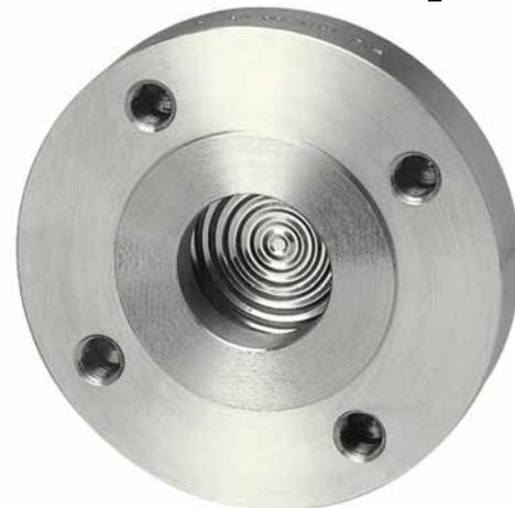
Разделительные диафрагмы предназначены для защиты чувствительного элемента манометров, реле давления и электронных датчиков давления от агрессивных сред технологического процесса, которые могут вызывать коррозию, иметь значительную вязкость, давать осадок и иметь высокую температуру. Рабочая сторона, соответствующая фланцу со стандартом ASME/EN 1092, подходит для применения в химической, и бумажной промышленности, а также при водоочистке
