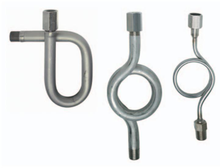
Хвостовики и кольцевые сифоны используются для измерения давления пара и устанавливаются между прибором (манометром, реле давления, датчиком давления) и технологическим процессом. Часть трубки всегда остается заполненной конденсатом и это позволяет избежать прямого контакта между высокотемпературным паром и прибором. Другим использованием этого оборудования является рассеяние тепла, что позволяет не допускать работы прибора при опасной температуре.
