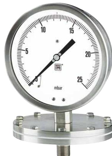
Чувствительным элементом является упругая диафрагма с концентрическим рифлением, которая передает усиленное перемещение через шаровое соединение. Инструменты сконструированы для измерения давления или вакуума вязких, образующих осадки, кристаллизующихся или корродирующих жидкостей. В сравнении с приборами, где чувствительным элементом служит трубка Бурдона, они более надежны и способны лучше противостоять превышению давления или агрессивным жидкостям.
