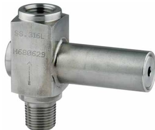
Эти устройства используются для защиты манометров и реле давления от перегрузки. Если в результате случайности давление превысит максимально допустимое значение, устройство автоматически будет направлять давление в обход манометра до тех пор, пока значение давления не возвратится в нормальное состояние.
