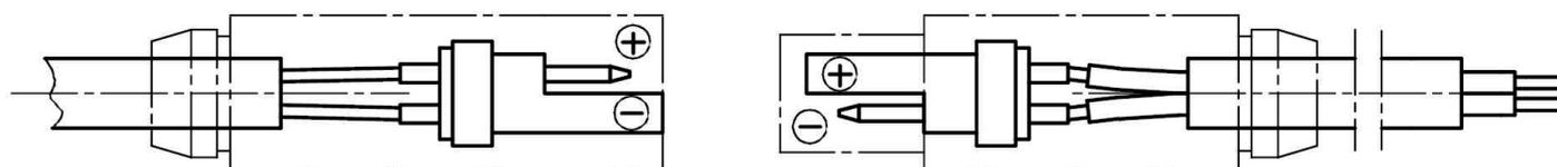
Рекомендуемые сечения компенсационных и удлинительных кабелей для соединения датчиков с внешними устройствами согласно PN-89/M-53859 составляют 1,0 мм<sup>2</sup> или 1,5 мм<sup>2</sup>.
