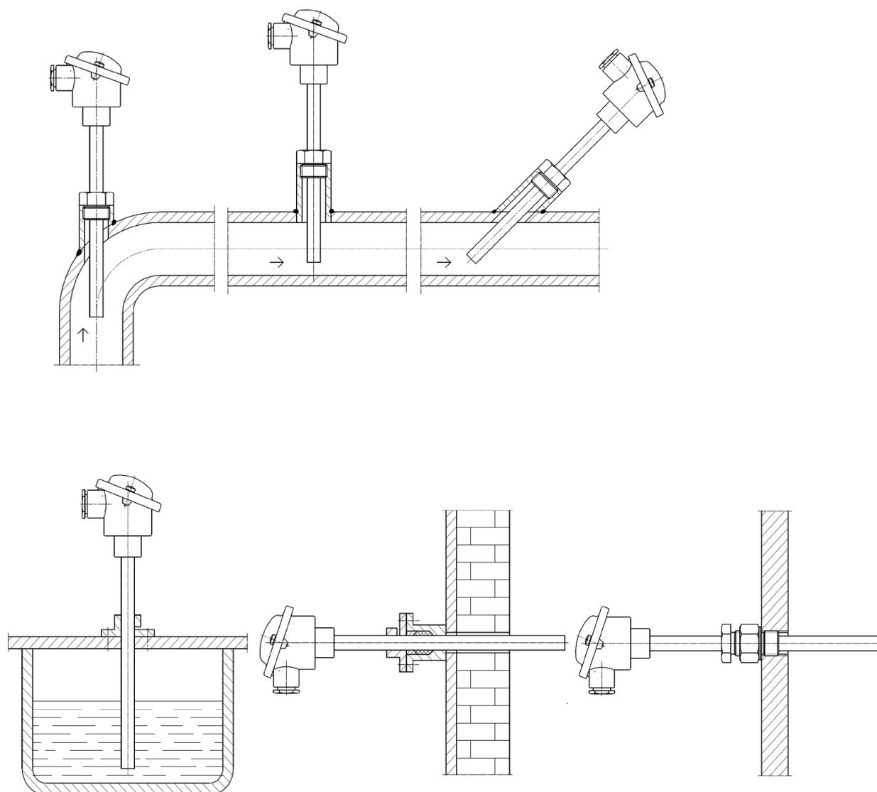
Примеры сборки датчиков в трубопроводе:
