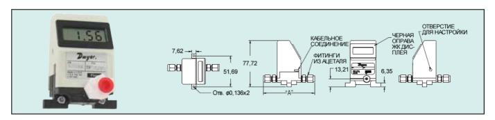
Расходомеры газа серии TFP-GI походят для работы с широким диапазоном промышленных, торговых и лабораторных приложений связанных с потоком. Эти расходомеры используют турбинное колесо и электрооптическое детектирование для преобразования расхода в линейный выходной сигнал в диапазоне от 0 до 5 В пост. тока для записи и регистрации данных. 3-1/2 цифровой ЖК дисплей информирует пользователя о действительном расходе. Для работы требуется адаптер питания или соответствующий соединительный кабель.
