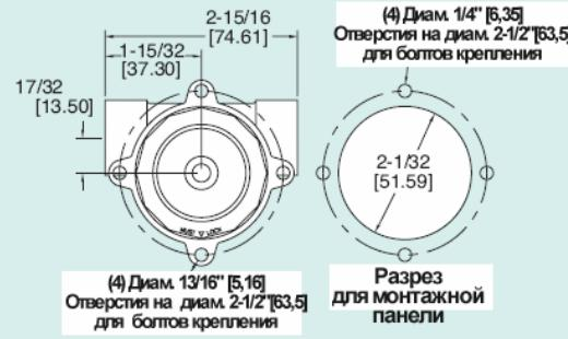
Разрез для монтажной панели
