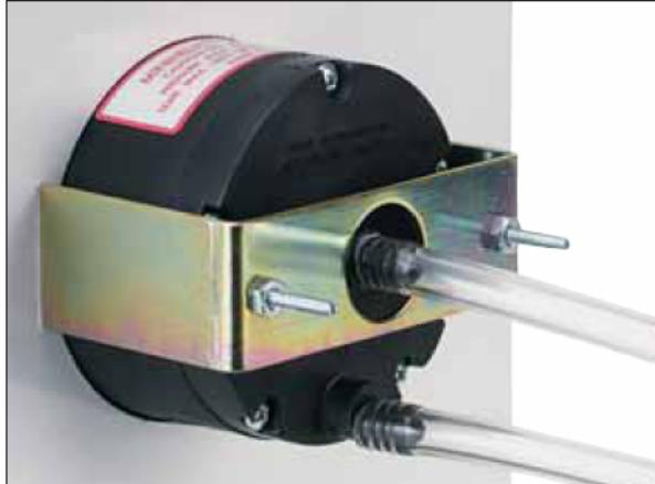
Для монтажа на панели в отверстии диаметром 67 мм вместе с измерителем Minihelic® II поставляется монтажное оборудование. Поставляемое оборудование может использоваться для панели толщиной до 13 мм. Если есть необходимость, на задней стороне измерителя используют монтажную пластину, которая может иметь два 4-40 винта пропускаемых через отверстия в монтажном кронштейне. Эта монтажная пластина должна иметь отверстия для двух штуцеров.
