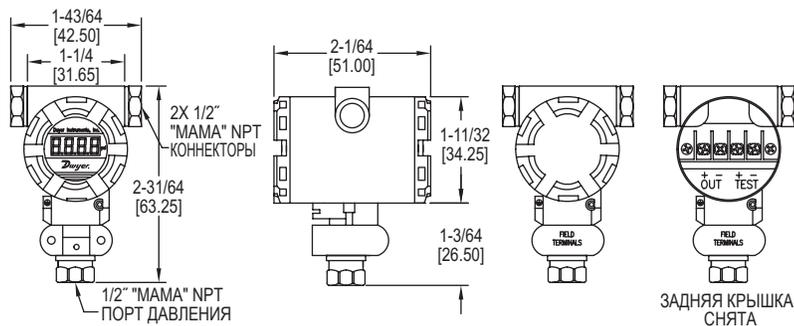
Промышленный всепогодный датчик давления серии IWP представляет собой исключительно ценное решение для измерения давления в промышленных условиях, требующих высокой производительности, стабильности и длительного срока службы. Точная работа в грязных и влажных условиях делает серию IWP идеальным выбором для применения в нефтяной, химической и металлургической промышленности.
