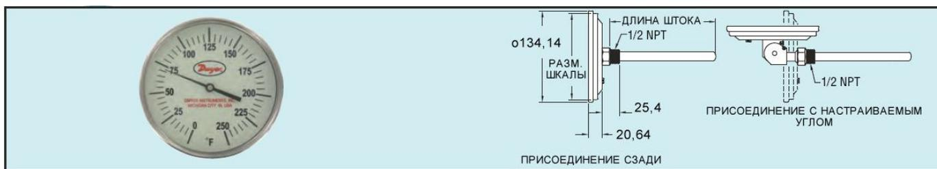
**Биметаллический термометр с подсветкой в темноте серии GBT.** Для легкого считывания показаний фон шкалы ярко подсвечивается при установке устройства в темном месте. Стеклянное окно можно легко почистить и для лучшей видимости шкалы, оно выполнено из стекла стойкого к царапинам. Термометры серии GBT могут заказываться с различными длинами штока, различными соединениями и диапазоном подходящими для большинства приложений.
