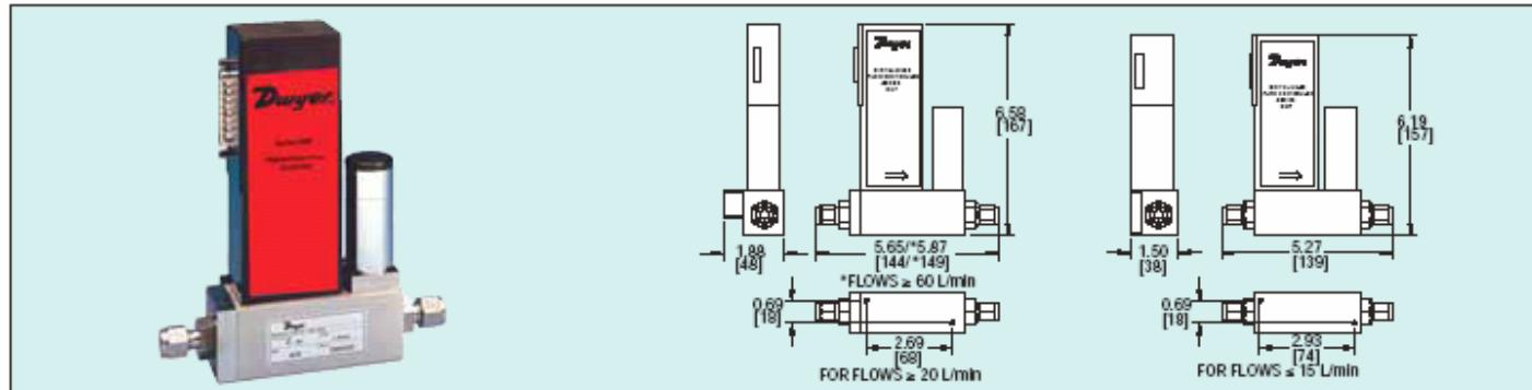
**Программирование, запись, анализ и управление** расходом газа в потоках газов различного вида при помощи цифровых регуляторов расхода газов серии **DMF**. Регуляторы имеют конструкцию с датчиком в виде прямой трубы с элементом ограничения потока для обеспечения ламинарности потока газа, обеспечивающей точные и повторяемые результаты. На работу регуляторов серии DMF не оказывают влияния изменения температуры и давления.
