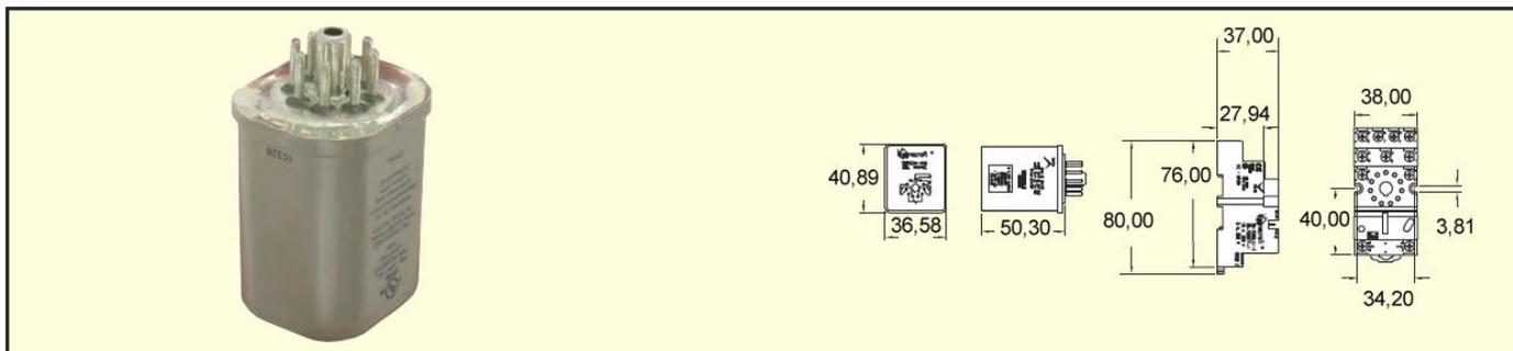
Герметично уплотненное электромеханическое реле серии 750Н сконструировано для использования в опасных зонах Класса I Раздел 2. Золоченные контакты обеспечивают защиту от окисления в приложениях с низким напряжением. Доступны 8 и 11 штырьковые разъемы, которые позволяют быстро и легко установить как на плоскости, так и на рейке DIN.
