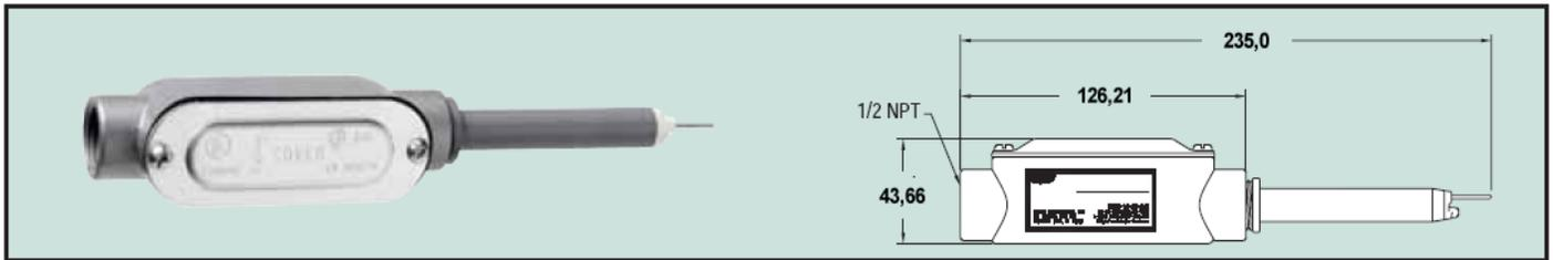
**Датчик скорости воздуха серии 641В** использует технологию нагретого сенсора в массовом потоке. Датчик имеет 4 выбираемых пользователем диапазона от 250 фут/мин до 2000 фут/мин с соответствующими диапазонами в метрических единицах от 1,25 м/сек до 10 м/сек. Серия 641В выдает изолированный выходной сигнал 4-20 мА пропорциональный скорости.
