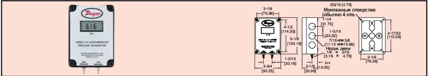
С помощью датчика дифференциального давления серии 616W могут быть измерены положительное, отрицательное и дифференциальное давление с точностью  $\pm 0,25\%$  для полной шкалы. Устройство размещается в поликарбонатном корпусе, герметизированном в соответствии с NEMA 4X (IP66), и обладает чувствительностью к давлению воздуха и совместимых газов. Устройство выдает стандартный выходной сигнал 4-20 мА.
