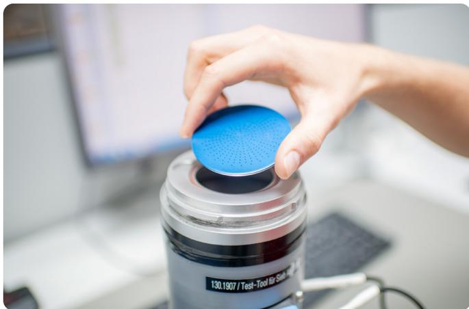
**Рисунок 7.** Алюминиевое сито проверяется на пропускание воздуха, так как анодирование влияет на диаметр отверстий и, следовательно, на скорость уплотнения.
