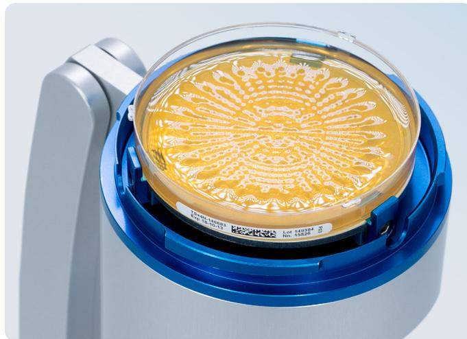
**Рисунок 2.** Стандартная 90-миллиметровая чашка Петри на пробоотборнике MAS-100 NT® для микробиологических проб воздуха. Хорошо виден рисунок уплотнения, образовавшийся при прохождении 1000 л воздуха со скоростью 100 сл/мин через перфорированную крышку размером 300 x 0,6 мм.
