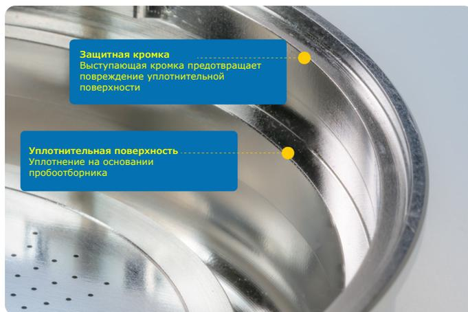
**Рисунок 4.** Перфорированная крышка из нержавеющей стали (в перевернутом виде). Защитная кромка предотвращает повреждение уплотнительной поверхности, что может привести к засасыванию воздуха через зазор.
