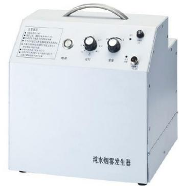
Генератор тумана YWF-01 представляет собой распылитель чистой воды. Он использует принцип ультразвука для производства большого количества водяного тумана размером 1-10 мкм. Водяной туман после выпуска через трубу с внешним давлением может представлять собой густой туман. Может применяться в различных сферах, особенно подходит для тестирования состояния воздушного потока в чистых помещениях.
