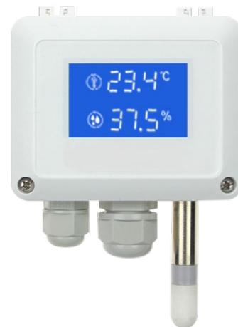
Датчики температуры и влажности MIRKIP MKTH500 применяются для измерения относительной влажности и температуры в различных системах вентиляции, кондиционирования и отопления (ОВиК), а также для мониторинга систем управления энергопотреблением зданий. Серия включает в себя датчики для монтажа в воздуховоды и настенные датчики с классом защиты IP65.
