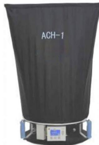
Балометр АСН-1 – это прибор, используемый для измерения объема воздуха, проходящего через воздуховыпускное отверстие, диффузоры и решетки. Прост в работе, обладает высокой точностью и надежностью, что обеспечивает точность измерения и возможность сохранения результатов.
