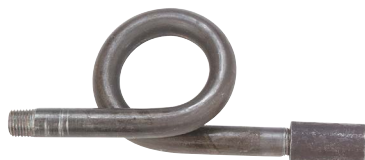
Pigtail siphon 42-52: 250 psig max 42-58: 2000 psig max
