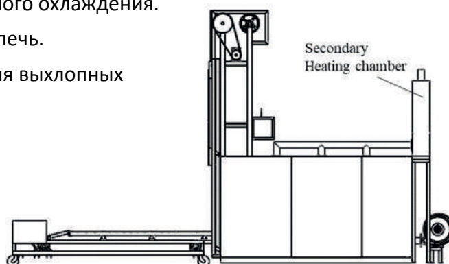
BHF с дополнительной нагревательной камерой для выхлопных газов
