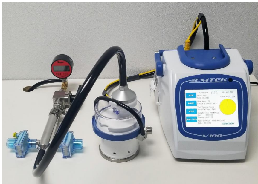
РИСУНОК 13: СТАНДАРТНАЯ УСТАНОВКА V100 ДЛЯ ОТБОРА ПРОБ RCG
