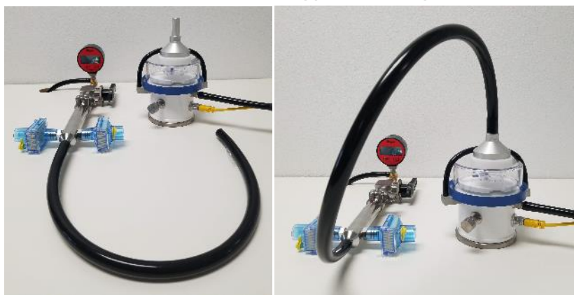
РИСУНОК 12: КРЕПЛЕНИЕ ТРУБКИ ДЛЯ ОБРАЗЦА К КУПОЛУ RCG
