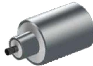
Триаксиальный кабель — это тип электрического кабеля, аналогичный коаксиальному, но с дополнительным слоем изоляции и второй токопроводящей оболочкой. Обеспечивает большую пропускную способность и лучшую защиту от помех по сравнению с коаксиальным кабелем.
