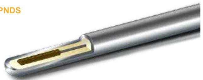
Самопитающиеся нейтронные детекторы (SPND) применяются в качестве датчиков нейтронного потока внутри активной зоны ядерных реакторов. Типичный SPND представляет собой коаксиальный кабель, состоящий из внутреннего электрода (эмиттера), слоя изоляции и внешнего электрода (коллектора).
