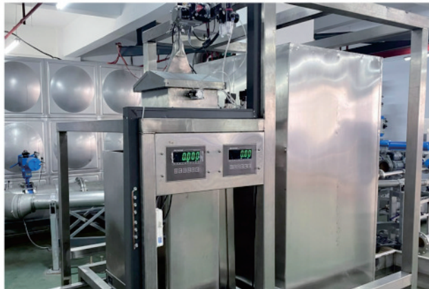
Установка для калибровки расхода воды по массе
