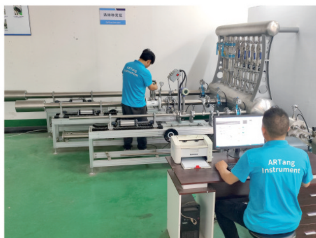
Газовая калибровочная установка
