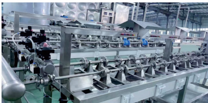
Калибровочная установка для измерения расхода воды
