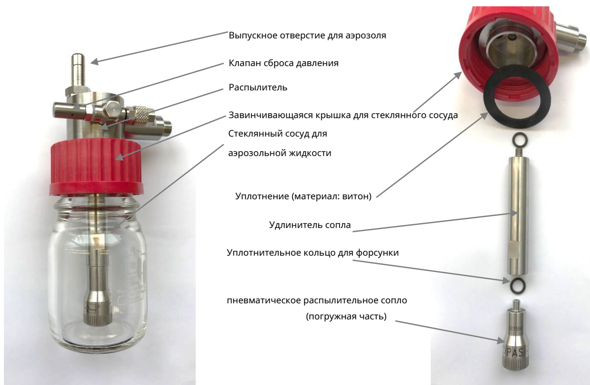
Рисунок 6 - Компоненты распылителя в смонтированном и разобранном состоянии
