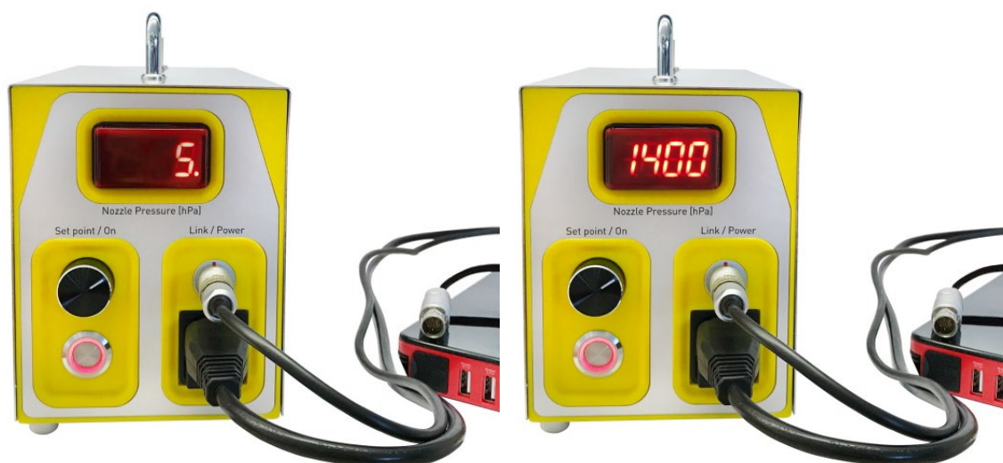
Рисунок 7 - Индикация давления в сопло (слева: установленное значение давления на входе в сопло с точкой справа, справа: считывание значения давления на входе в сопло)
